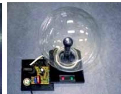
Teslin generator VF struje
